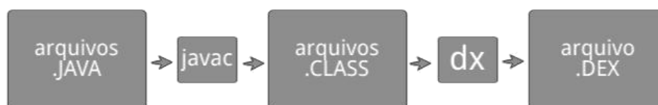
Figura 2.2 Transformação de código fonte Java em Dex
