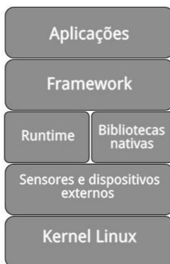
Figura 2.1 Camadas do sistema Android.
