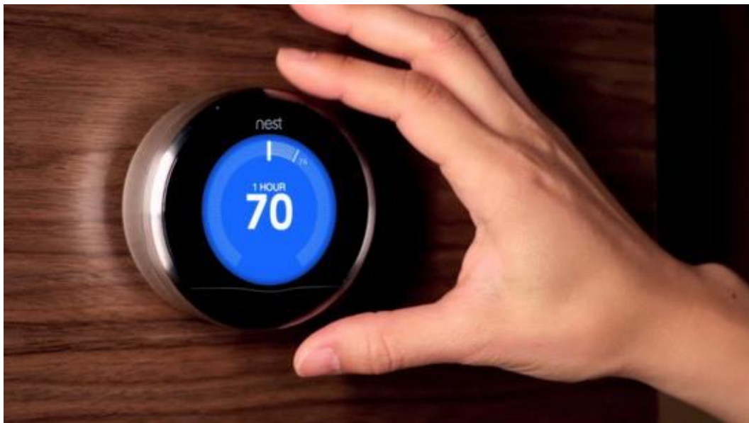
Figura 13 - Interação com o termostato NEST da Google.
